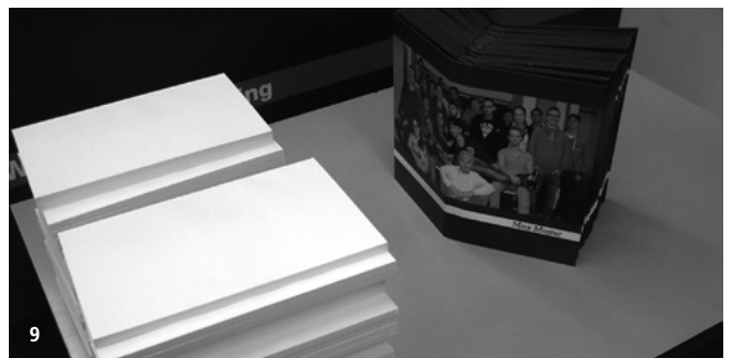
1 Das fertige Produkt - Individualisierter Papierband (LF 9). 2 Einrichten des Klebbinders. 3 Ableimen der Buchblöcke. 4 Gefälzelte Buchblöcke. 5 Beschneiden der Buchblöcke. 6 Belemen des Deckenbezuges. 7 Decke fertigen. 8 Buchdecken vor dem Prägen. 9 Buchblöcke und Decken vor dem Einhängen der Blöcke.
